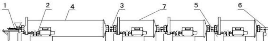
1、独立给料机 2、高压电机齿轮传动系统 3、串联加球装置 4、串联式连续球磨机的一级球磨罐 5、基础 6、提流出料装置 7、串联式连续球磨机的二级球磨罐。
