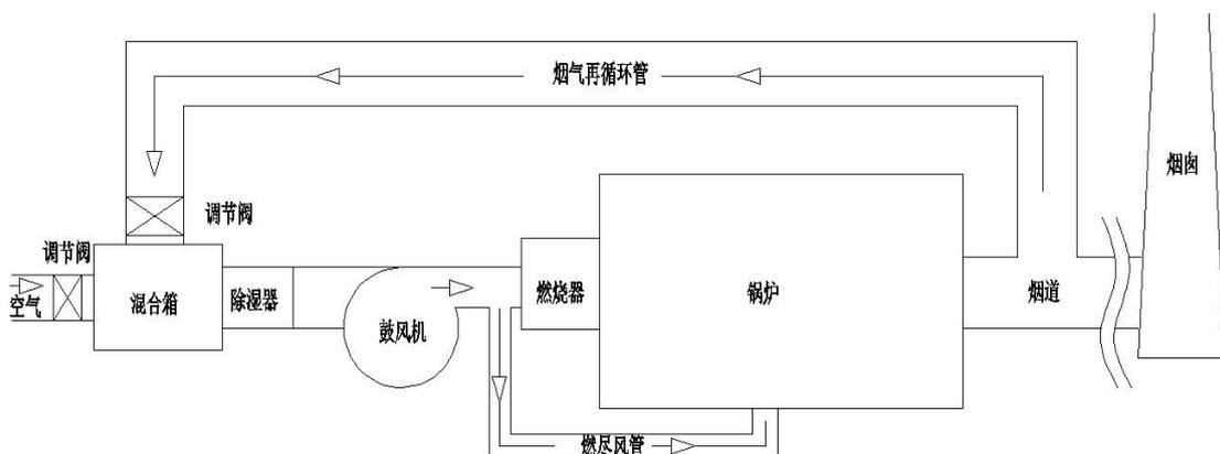
循环系统(OFGR)、燃尽风系统实现燃气的低氧、低背压、高效燃烧。锅炉烟气含氧量降低至 2-2.7%，系统背压降低 2000Pa以上，NO<sub>x</sub>排放≤28mg/Nm<sup>3</sup>。工艺流程如下：
