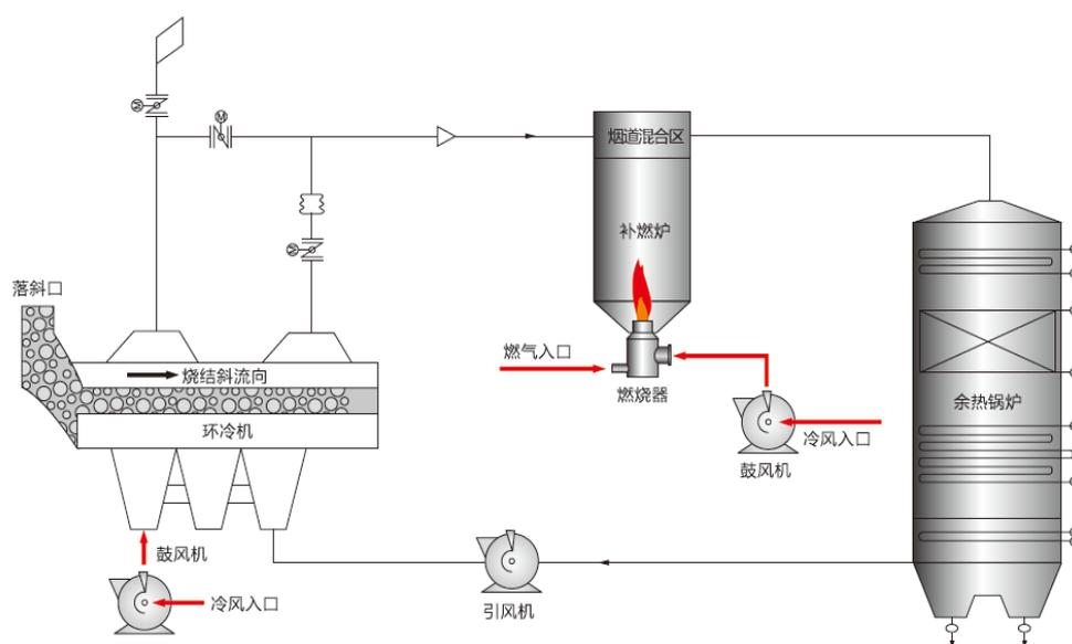
气)通过烟气发生装置产生高温烟气与锅炉所需余热烟气进行均匀混合换热,通过对烟气流量、温度的监控调节,实现余热锅炉和发电系统热力参数优化及动态特性优化,提高余热发电系统的稳定性。
