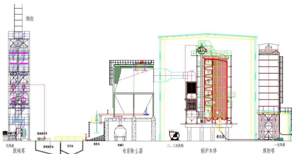
通过以废治废方法治理煤炭燃烧所产生的 SO<sub>2</sub>、NO<sub>x</sub> 排放的有害气体（雾霾源），以达到真正煤炭清洁高效燃烧外，在不外加任何其它脱硝脱硫添加剂下，达到天然气排放标准。高效粉体工业锅炉微排放一体化系统采用最适合粉状燃料燃烧的室燃炉，配套精密粉体储供系统、低氮空气分级燃烧系统、FGR 炉内脱硝、余热回收、高效布袋除尘、粉煤灰湿法脱硫和全过程智能化自动控制系统。
